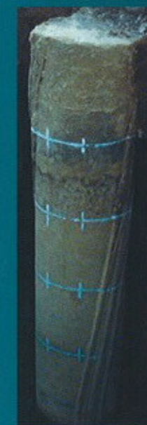
築造コラムの出来形確認 (柱状形状)
